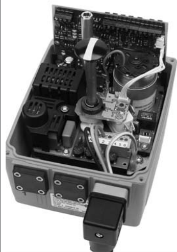
EA 21 mit montiertem Stellungsregler und Positionserfassung.
