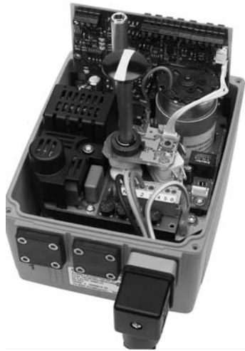
EA 21 mit montiertem Stellungsregler und Positionserfassung.
