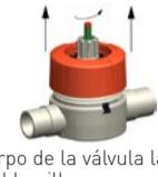
8. Saque del cuerpo de la válvula la carcasa interior y el ensamblaje del husillo.
