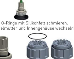
10. Vor Montage alle O-Ringe mit Silikonfett schmieren. O-Ring auf Spindelmutter und Innengehäuse wechseln
